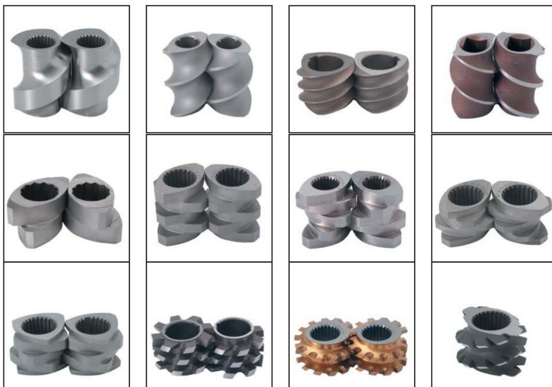
Obr. 2.19. Základné tvarové riešenia segmentov modulárnych dvojzávitoviek [7]
