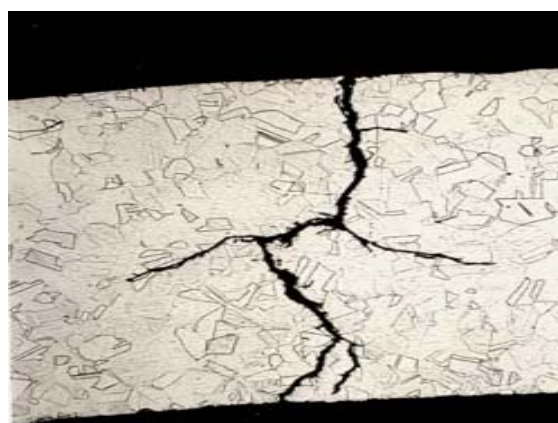
d) transkryštálová korózia - korózne trhliny
