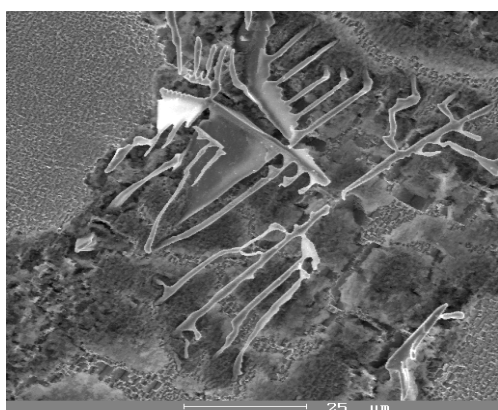
a) primárny karbid MC v ŽS6K, lept. Marble,
