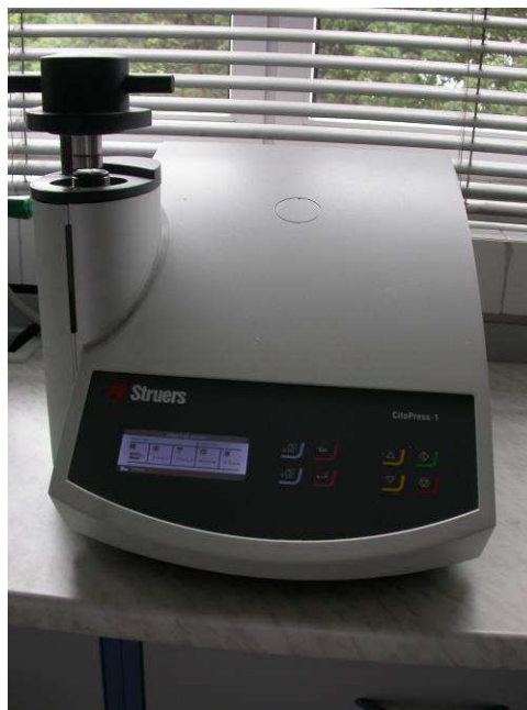
Obr. 5 Automatické zariadenie pre zalisovanie vzoriek za tepla Citopress firmy Struers
