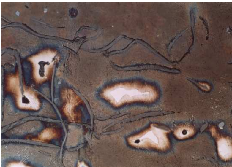
Obr. 64 Perlitická liatina s lupienkovým grafitom, lept. Klemm, svetlé pole, zv. 200x
