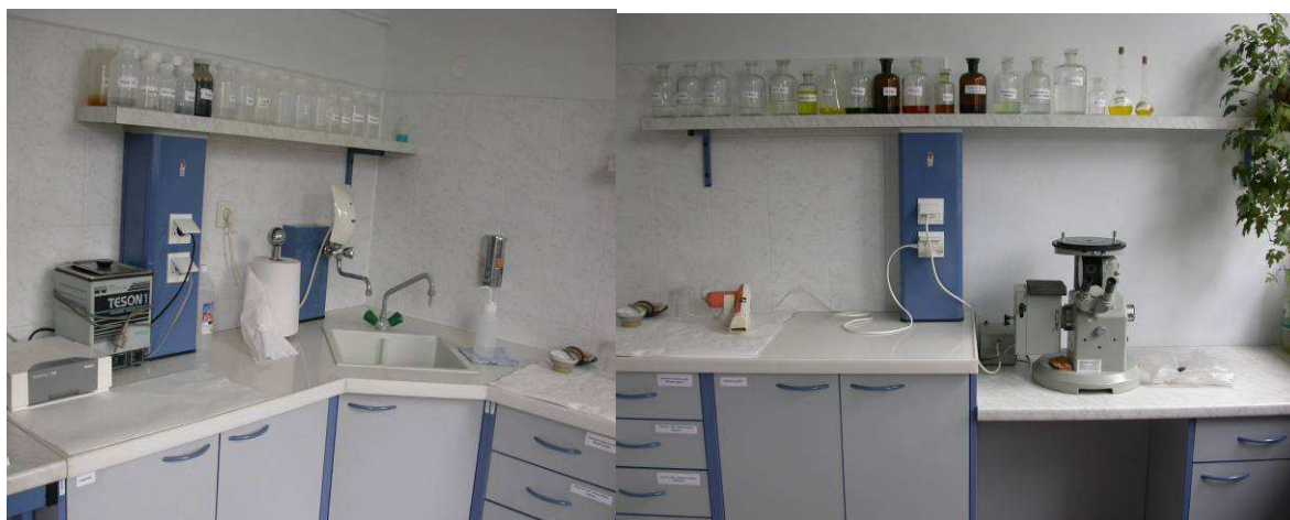
Obr. 22 Priestor pre leptanie, oplachovanie a sušenie vzoriek a svetelný metalografický mikroskop Epityp
