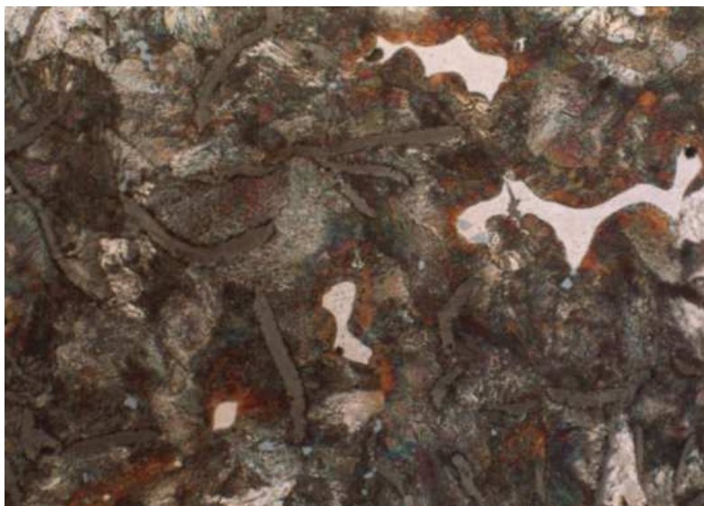
Obr. 63 Perlitická liatina s lupienkovým grafitom, lept. kyselina pikrová, svetlé pole
