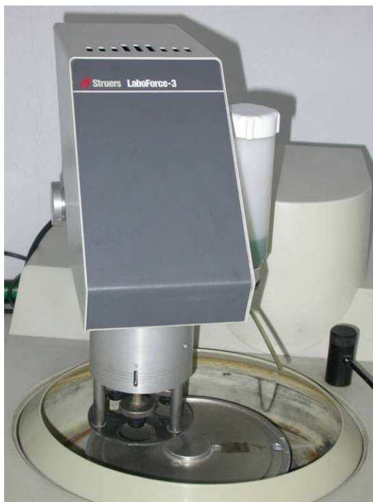
Obr. 12 Poloautomatická leštička LaboForce-3 firmy Struers
