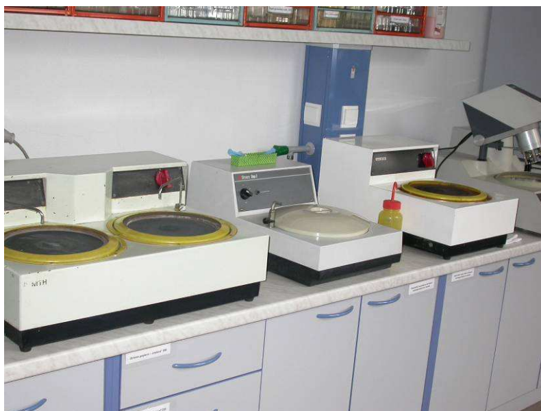
Obr. 9 Mechanická dvojkotúčová brúska firmy MTH, mechanická leštička firmy Struers a MTH
