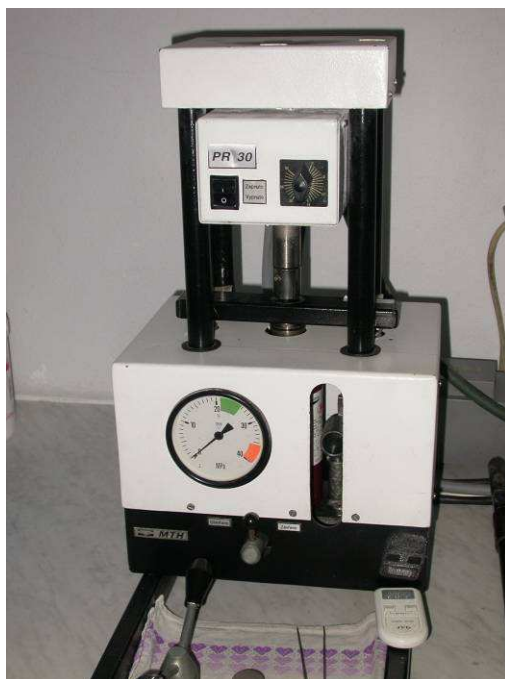
Obr. 4 Poloautomatické zariadenie pre lisovanie za tepla, prístroj firmy MTH
