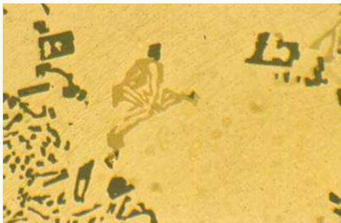
Obr. 69 Silumín \text{AlSi10MgMn} , nemodifikovaný, intermetalické fázy
