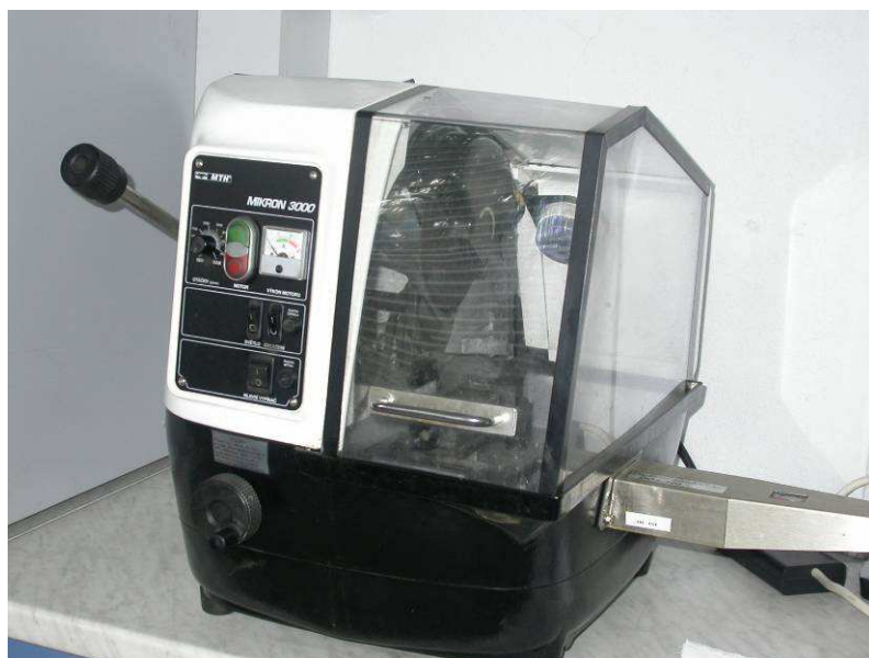
Obr. 2 Presná píla na rozbrusovanie metalografických vzoriek firmy MTH
