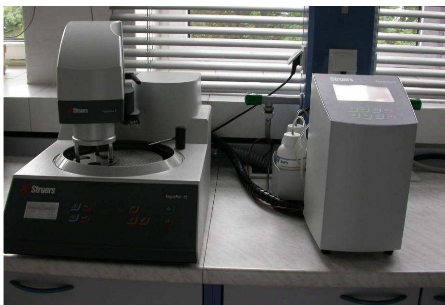
Obr. 14 Automat na prípravu metalografických vzoriek TegraSystem firmy Struers
