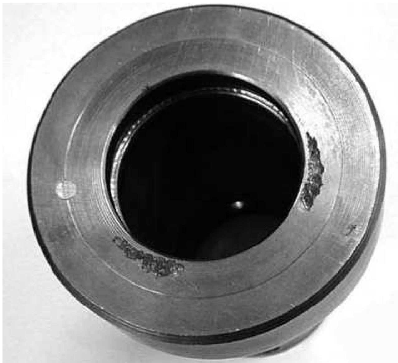
Škvrnitá korózia na antikoroéznej oceli
