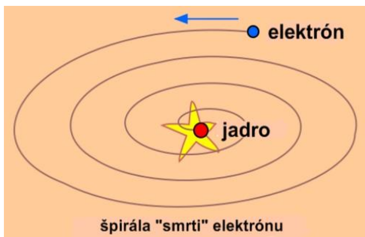
Obr. 2.3 Nedostatok Rutherfordovho modelu - pohyb elektrónu po špirále „smrti“
