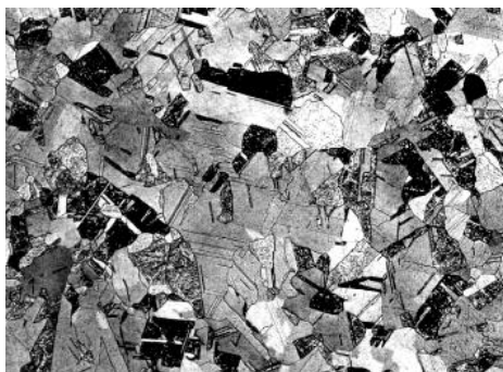
Obr. 2.24. Príklad štruktúry po plastickej deformácii dvojčatením na metalografickom výbruse
