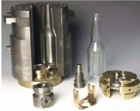
Obr. 14 Príklad kovovej sklárskej formy
