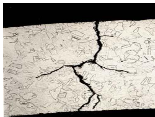
Transkryštálová korózia - korózne trhliny
