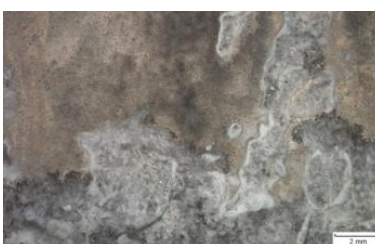
b) AZ91 po expozícii 48 h v soľnej hmle 5 % NaCl, vrátane koróznych produktov
