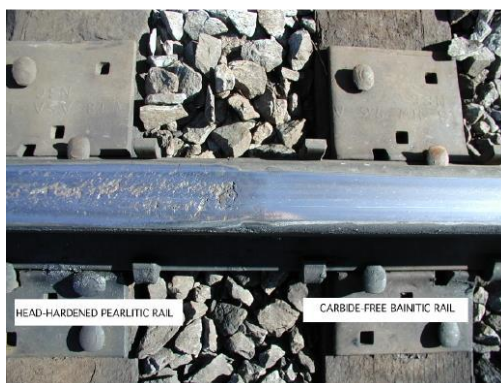
Obr. 2.29 Porovnanie opotrebenia perlitickej (vľavo) a bainitickej (vpravo) koľajnice
