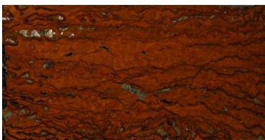
d) uhlíková oceľ po expozícii 48 h v soľnej hmle 5 % NaCl, vrátane koróznych produktov
