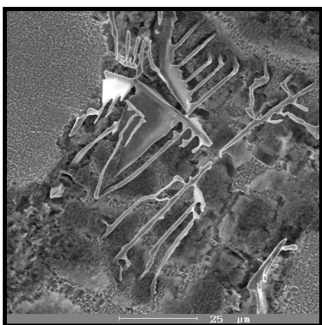
a) primárny karbid MC v ŽS6K lept. Marble
