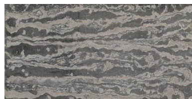
d) uhlíková oceľ po expozícii 48 h v soľnej hmle 5 % NaCl, po odstránení koróznych produktov
