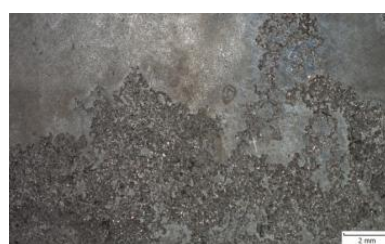
c) AZ91 po expozícii 48 h v soľnej hmle 5 % NaCl, po odstránení koróznych produktov
