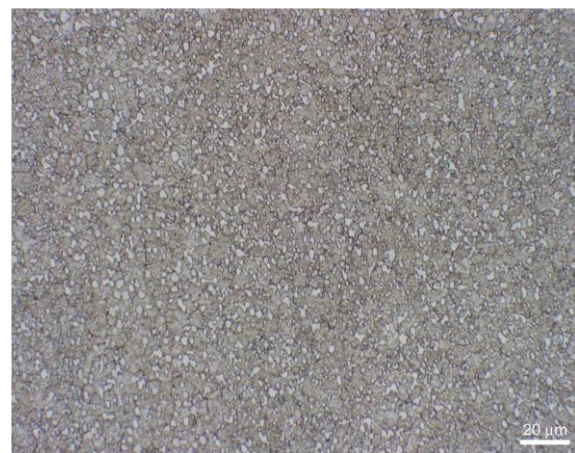
f) nástrojová oceľ PM - VANADIS 23 vyrobená metódou práškovej metalurgie
